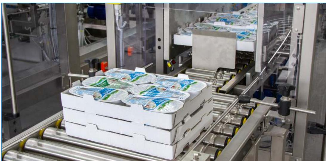
Maschine der Serie 720 integriert mit einer Rotationsabfüllanlage für fertige Becher (Serie 200) und mit einer Pick & Place Anlage (Serie 760)
